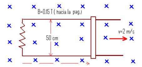
21.- La barra de metal de longitud L, masa m y resistencia R, que se indica en la fig., se desliza sin fricción sobre un circuito rectangular compuesto de alambre de resistencia despreciable que se encuentra sobre un plano inclinado. Ahí existe un campo magnético B vertical .Encuentre la velocidad Terminal de la barra (esto es, la velocidad constante con que logra obtener)
