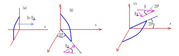
7.- La espira de cuarto de círculo mostrada en la fig. Tiene una área de 12 cm<sup>2</sup>. Existe un campo magnético con B=0.20T en la dirección de +x . Encuéntrese el flujo magnético a través de la espira para cada una de las orientaciones mostradas.
