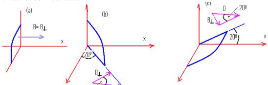
8.- Una superficie semiesférica de radio R se coloca en un campo magnético B como se muestra en la fig. .Calcule el flujo magnético a través de la superficie semiesférica.
